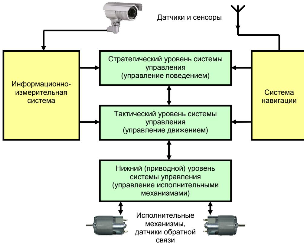
**Рис. 1 Классическая структурная схема интеллектуальной системы управления мобильным роботом**
