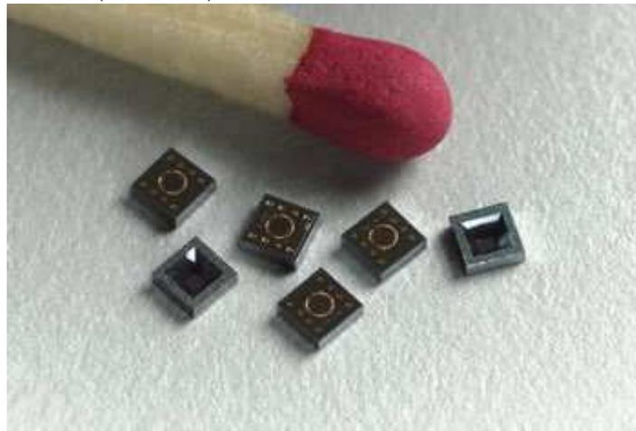
**Рис. 62** Микромеханические гироскопы
